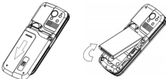
**Pasang:** (1) Masukkan baterai ke dalam celah baterai, perhatikan bahwa ujung bawah baterai harus masuk terlebih dahulu. (2) Letakkan penutup belakang secara merata ke arah tubuh telepon. Langsung arahkan tutup belakang ke tempat penguncian di bagian atas/samping dari telepon. Dan dorong tutup belakang telepon untuk menguncinya pada tempatnya.
