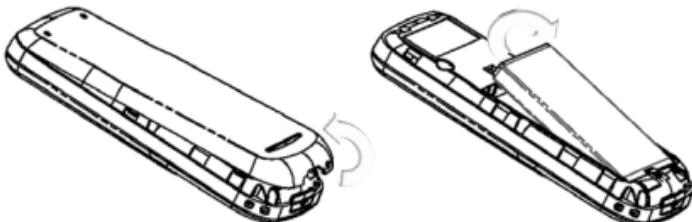
**Pemasangan:** (1) Masukkan baterai kedalam celah baterai. Untuk diperhatikan ujung bawah dari baterai yang dimasukkan. (2) Letakkan penutup belakang atas seperti yang terlihat di gambar. Masukkan penutup belakang bawah ke untuk mengunci bagian atas dari telepon dan tekan penutup belakang telepon untuk mengunci semua bagian.
