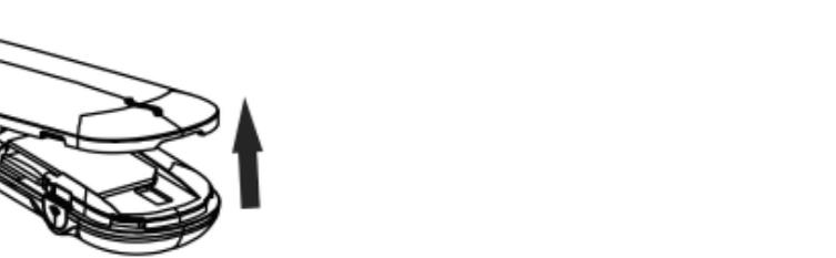
2. Mantenga su tarjeta SIM / USIM con la esquina cortada orientada como se muestra a continuación, luego deslice el soporte de la tarjeta con los contactos metálicos hacia el modem.
