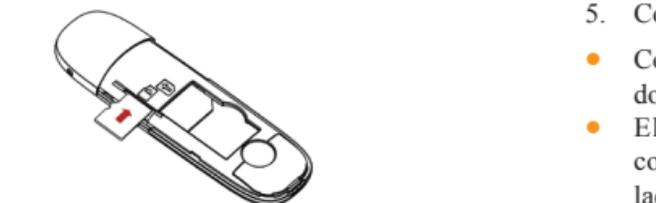
4. Ponga la tapa frontal del modem de plano sobre el cuerpo de modem. Dirija la cubierta frontal hacia las pestañas de bloqueo en los lados del modem y empuje la cubierta frontal del modem para asegurar la cubierta frontal en su lugar.
