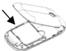
Retire la batería Presione la batería y vuelva a colocar la cubierta de la batería
