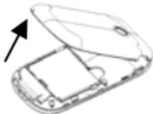
Retire la cubierta de la batería
