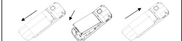
Retire la cubierta de la batería Empuje la batería hacia abajo Reinstale la cubierta
