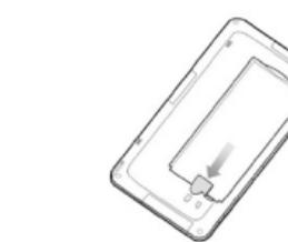
2. Inserte la tarjeta microSD (ya se puede insertar)
