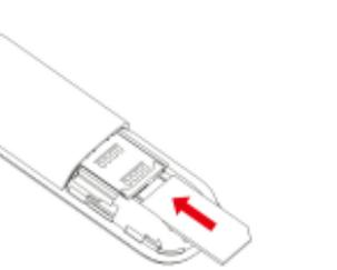
3. Si es necesario, inserte la tarjeta microSD en el espacio para la tarjeta microSD hasta sentir que haga clic. Asegúrese de que los contactos de metal de la tarjeta de memoria estén como se muestra en la figura sobre la derecha.
