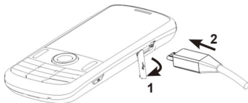
1. Dégagez le couvercle en caoutchouc qui protège le connecteur de charge de USB et déplacez-le à l'écart.
