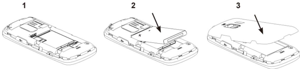
1. Insérez la batterie en alignant avec les contacts (1) et pressez légèrement jusqu'à ce qu'elle s'enclenche en position (2).
