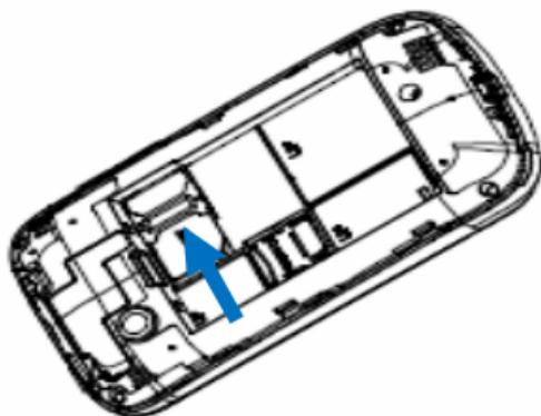
3. Siga la flecha ABRIR para empujar la ranura de metal, y darle la vuelta para arriba. Inserte la tarjeta de memoria en la ranura de metal con los contactos metálicos hacia abajo hasta que encaje en la posición correcta. Mueve la ranura de metal y bloquéelo.
