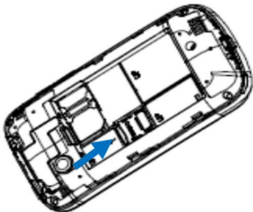
4. Inserte la batería alineando los contactos dorados de la batería con los contactos dorados en el compartimiento de la batería. Empuje suavemente hacia abajo la batería hasta que encaje en su lugar.
