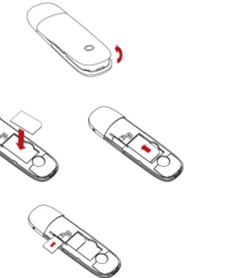
4. Coloque a cobertura de frente do modem terminantemente sobre o corpo do modem. Posicione a cobertura de frente em direcção às pegas de fechadura nas partes laterais do modem e aperte a cobertura de frente do modem, no sentido de travar a cobertura de frente ao seu lugar.
